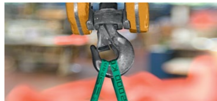
Schmäler ist besser: Das gilt ganz besonders für kleine Kranhaken.
