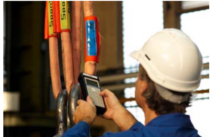
Rundschlingen müssen mindestens einmal jährlich auf Mängel untersucht werden.
